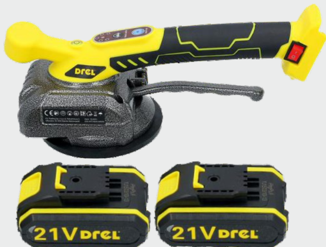
DREL VIBRAČNÁ PRÍSAVKA NA DLAŽDICE 130 mm, kapacita batérie 1500 mAh, max. nosnosť: 50 kg, 5-stupňové nastavenie vibrácií
