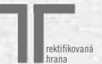
Dlaždice se ještě jednou zpracují po vypálení (srovnají), díky čemuž získají jednotnou velikost s hranami v úhlu 90°. Díky tomu je možné dlaždice pokládat se spárou o minimální šířce 1,5 až 2 mm. Celkový obraz spár bude působit rovnoměrněji a údržba nebude tak náročná, protože se nebude v úzkých spárách usazovat zdaleka taklik nečistoty.
