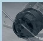
Hinterradnabenmotor (40 Nm) für direkte Kraftübertragung
