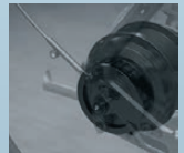
Hinterradnabenmotor (40 Nm) für direkte Kraftübertragung
