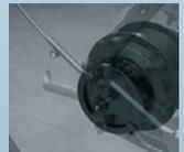
Hinterradnabenmotor (40 Nm) für direkte Kraftübertragung
