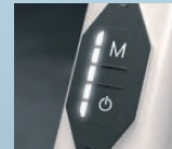
LED-Display zeigt gewählte Unterstützungsstufe und Akkustand
