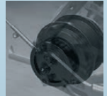
Hinterradnabenmotor (40 Nm) für direkte Kraftübertragung
