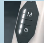
LED-Display zeigt gewählte Unterstützungsstufe und Akkustand
