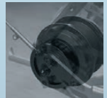
Hinterradnabenmotor (40 Nm) für direkte Kraftübertragung
