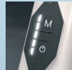
LED-Display zeigt gewählte Unterstützungsstufe und Akkustand
