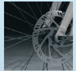
Hydraulische Scheibenbremsen der Marke TEKTRO
