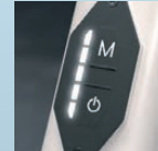
LED-Display zeigt gewählte Unterstützungsstufe und Akkustand
